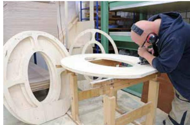
3. Die inneren Schichten werden von Hand ausgefräst, damit die Buchstaben nicht zu schwer werden.
