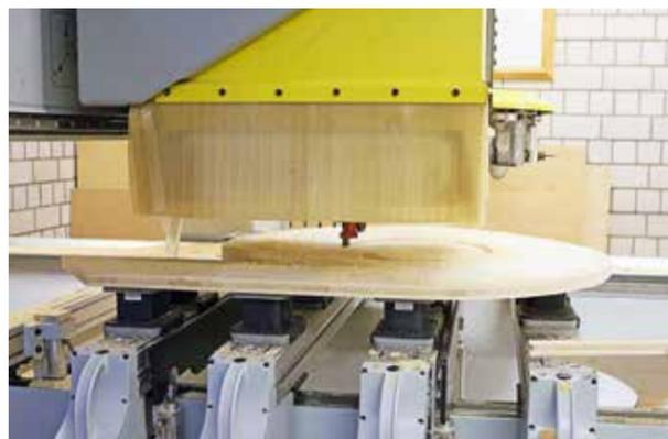
2. Auf der CNC-Maschine werden die Buchstabenplatten ausgefräst. Acht Schichten ergeben einen Buchstaben.
