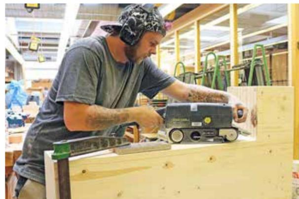
4. Acht Schichten werden miteinander verleimt und anschließend geschliffen.
