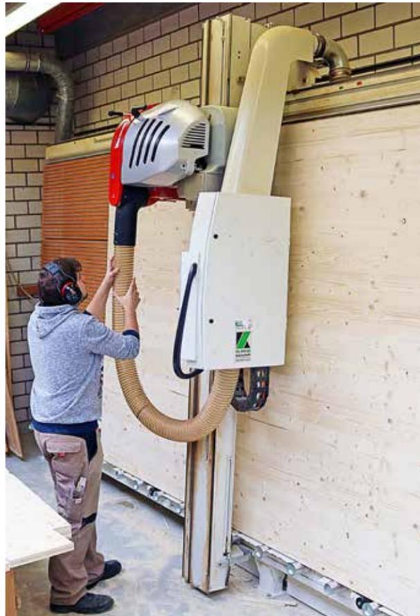
1. Aus 2 x 5 Meter großen Platten werden die Teilstücke mit der stehenden Plattensäge zugeschnitten.
