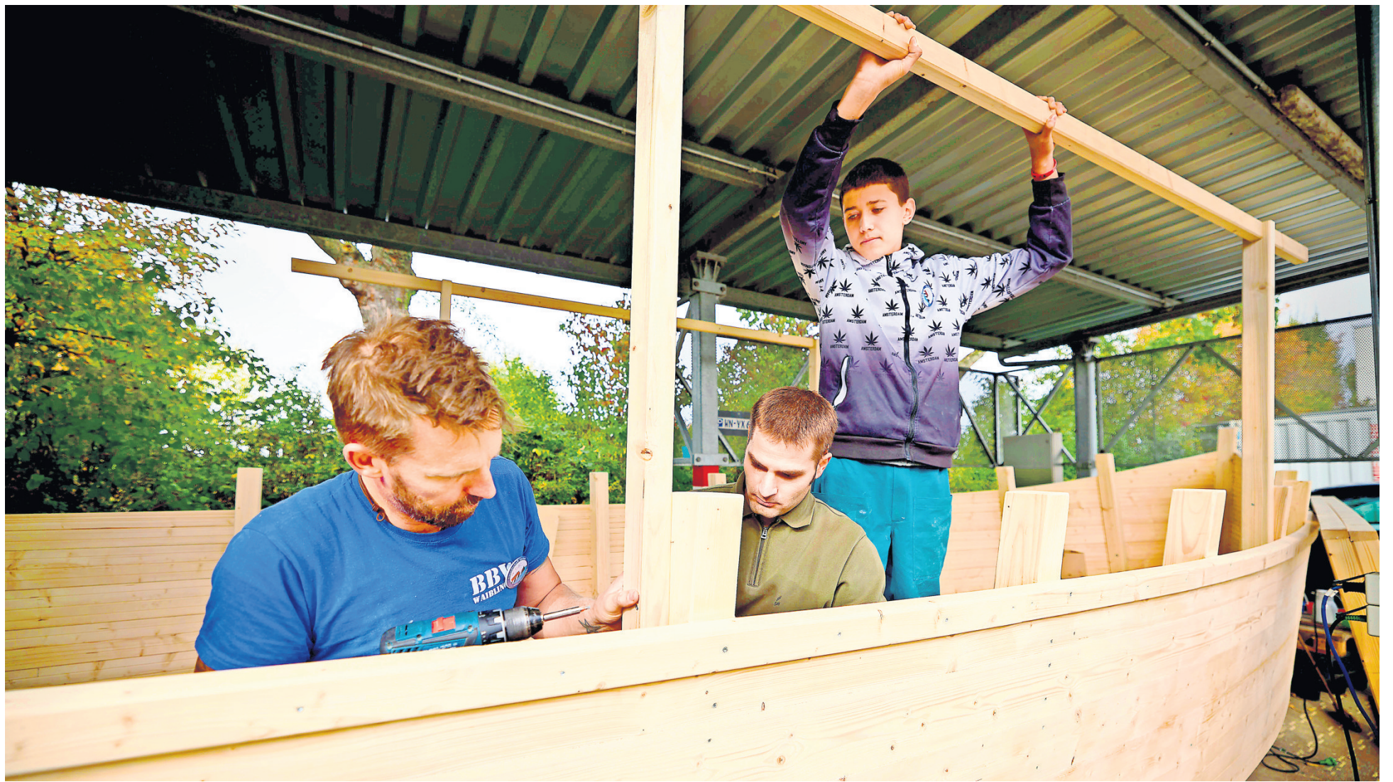
In Teamarbeit schrauben Azubis aus Waiblingen und Baja eine Ulmer Schachtel zusammen – ein flaches Flussschiff, mit dem einst Waren auf der Donau transportiert wurden. Foto: Gottfried Stoppel
